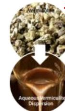
Dispersion Aqueuse de Vermiculite, Brouillard formant 1 film protecteur contre l'oxygène.
