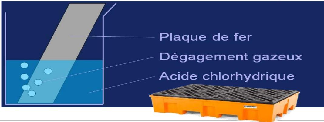
**Production d'hydrogène (H<sub>2</sub>)**
