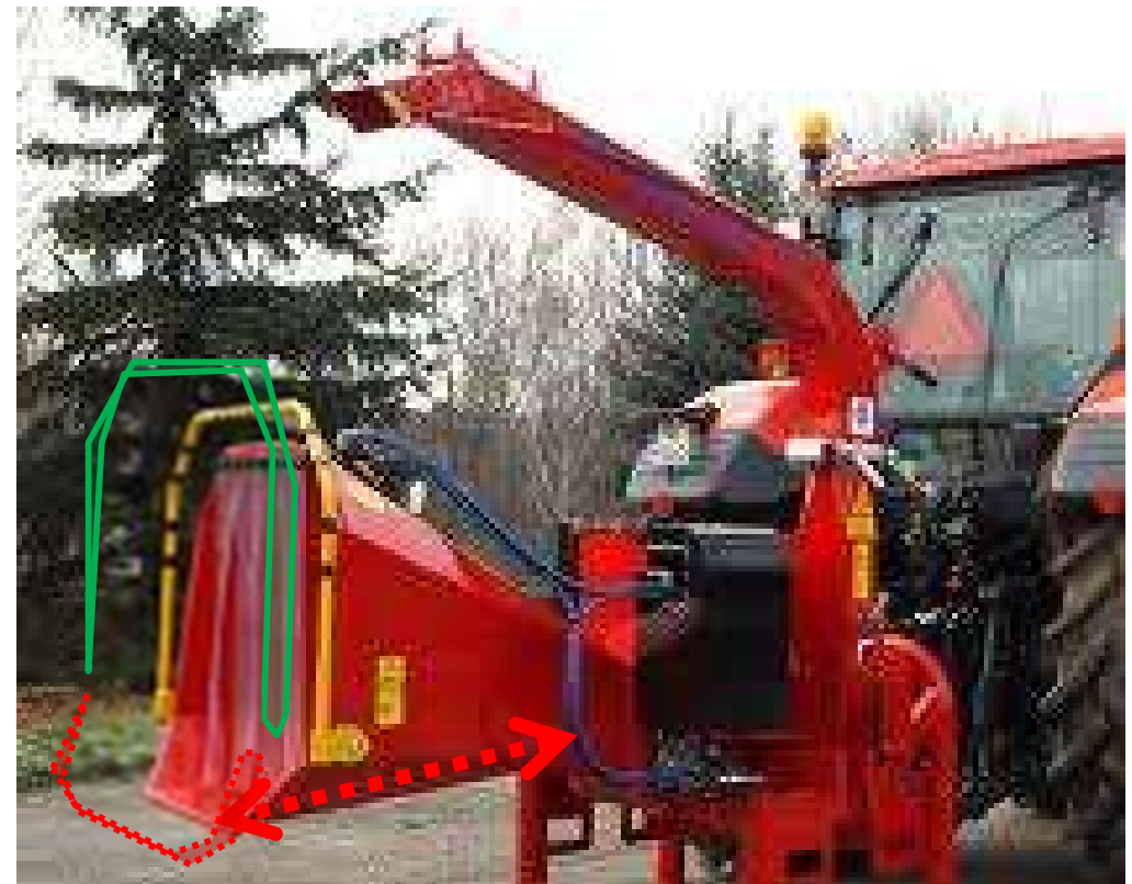
Broyeur déchiqueteur non conforme (absence de barre sensible face – goulotte )
