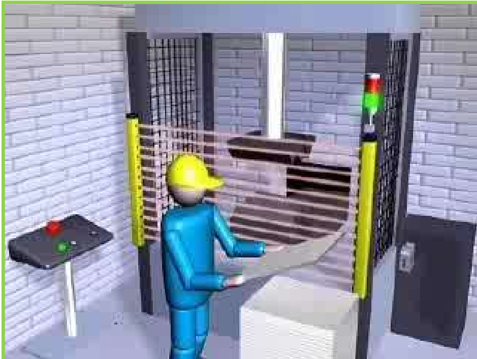
Zone dangereuse derrière un barrage immatériel
