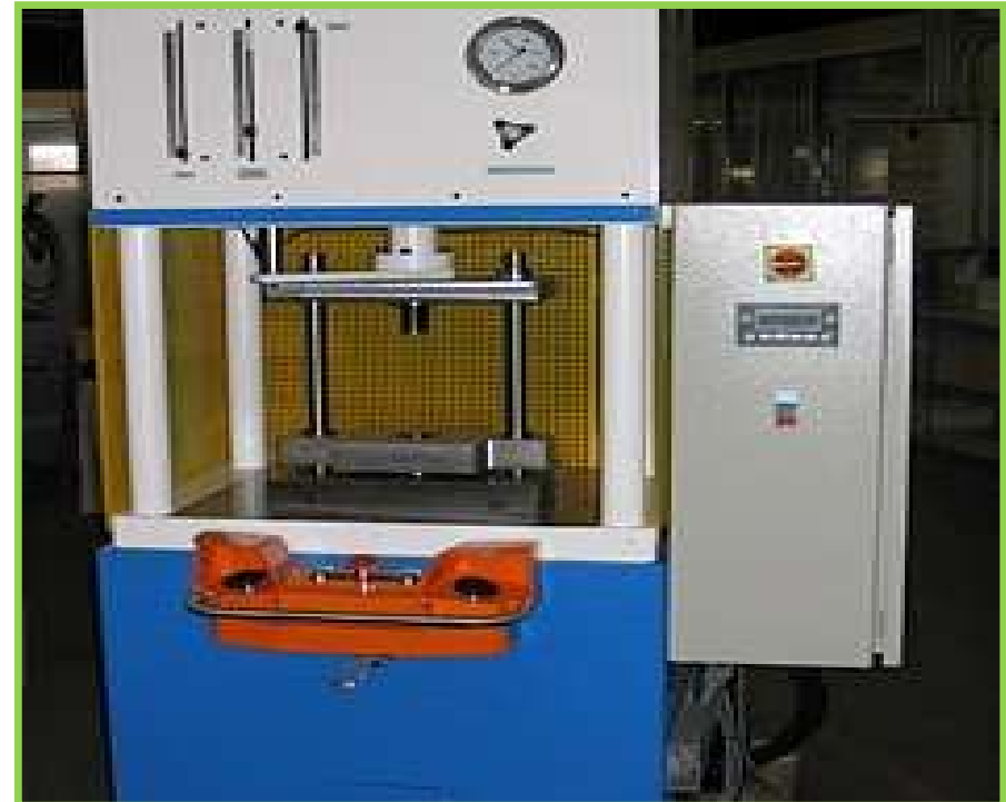
Presse avec commande bi-manuelle
