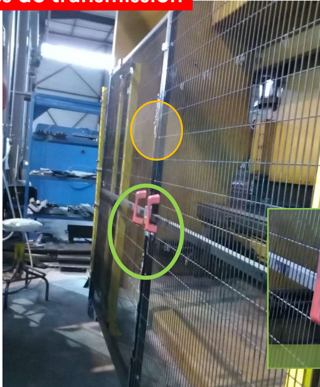
Arrière d'une machine – grille empêchant l'accès aux éléments de transmission
